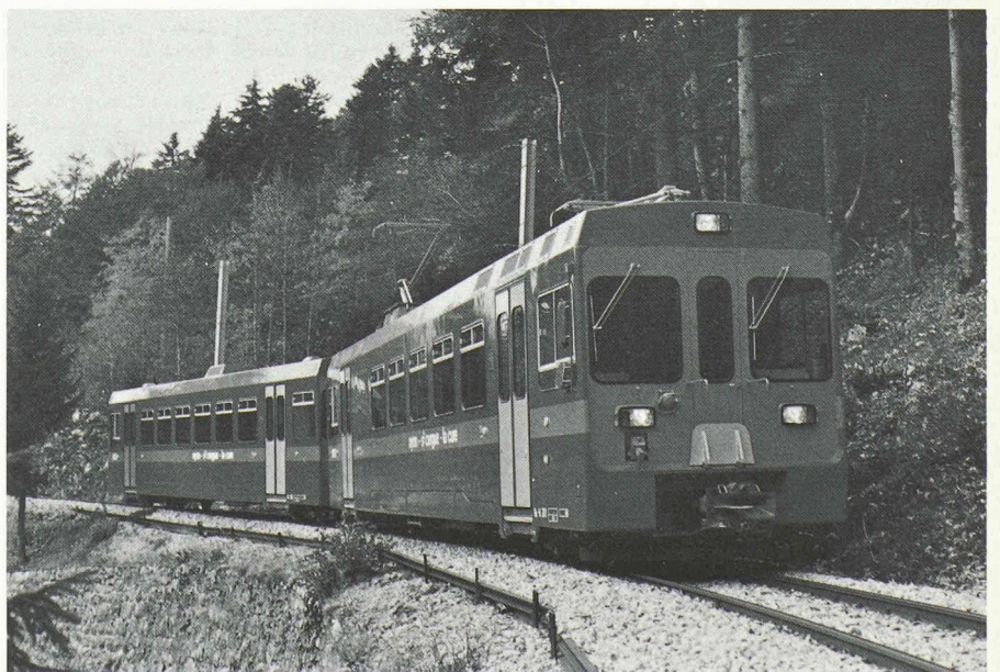
La première rame-navette, composée de l'automotrice Be 4/4 201 et de la voiture-pilote Bt 301, en service entre La Cure et Saint-Cergue. Elle représente l'unité de base pour les trains horaires. Grâce à leurs deux cabines de conduite, les automotrices peuvent aussi circuler seules. La possibilité de conduite en unités multiples par un seul agent, permet à un train comportant deux motrices et quatre voitures de transporter 896 personnes, dont 436 en places assises.
