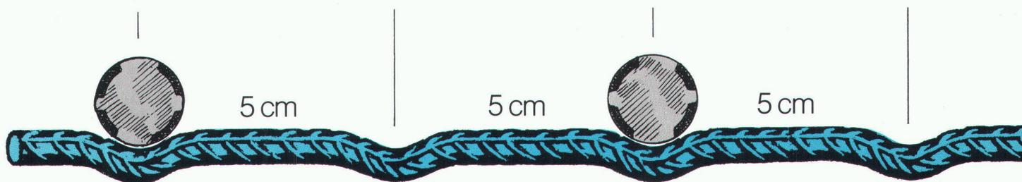
Des encoches «fix», espacées de 5 cm exactement, caractérisent les barres de support des nouveaux paniers de support DK fix. Sans frais supplémentaires, DK fix offre les avantages suivants:
