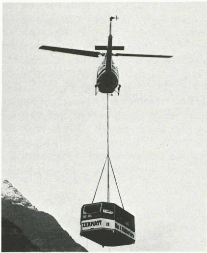
Recours à l'hélicoptère (1979) alors le plus puissant de Suisse (Bell 214 d'Hélicwiss, à Berne) pour amener de Täsch à Trockener Steg une des deux cabines de 100 places du Petit-Cervin: 1965 kg!
