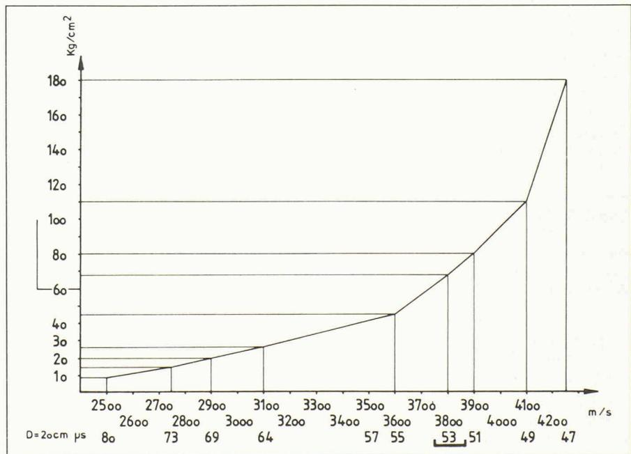
Fig. 3. — Relation entre la vitesse du son et la résistance du béton.
