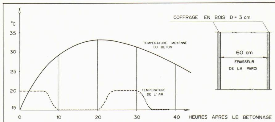
Fig. 1. — Variation de la température du béton.
