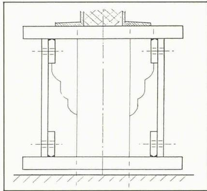
Fig. 3. — Coupe type de la poutre.
