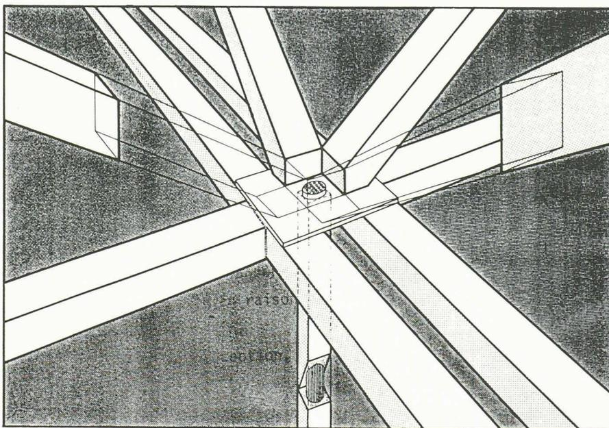
Fig. 3. - Vue éclatée d'un nœud de la structure.
