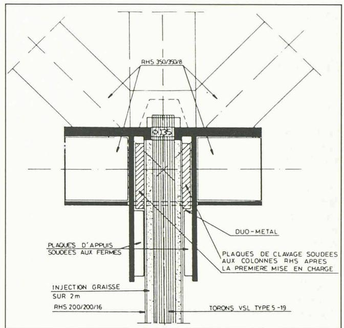
Fig. 2. - Détail d'un nœud de la structure.
