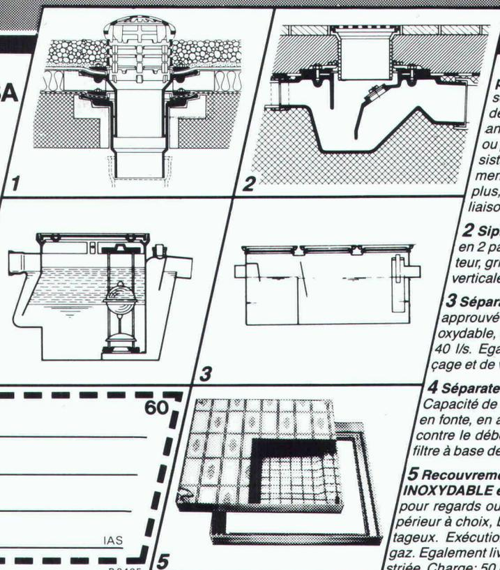
**1 Garniture d'écoulement en fonte pour toiture, PASSAVANT,** sorties verticale et latérale en une ou deux parties, réglable en hauteur avec anneaux de surélévation, grille sphérique, ou plate, ronde ou carrée, praticable, ou résistant au trafic lourd. Pourvue, non seulement d'une surface de collage, mais avec en plus, d'une bride de fixation assurant une liaison très résistante. Approuvé **ASPEE**.
