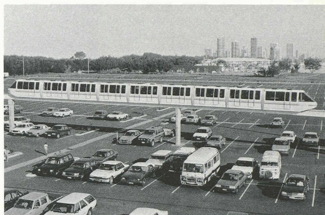
Là où le tracé n'est pas libre et où les coûts énormes d'un métro ne se justifient pas, la troisième dimension offre une échappatoire. Le monorail surélevé Von Roll Habegger connaît un succès croissant de par le monde, grâce à la relative modestie de l'infrastructure qu'il demande. (Photo Von Roll : Seaworld, Australie.)
