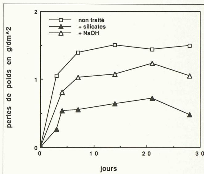
Fig. 3. — Pertes de poids dans l'eau dure.
