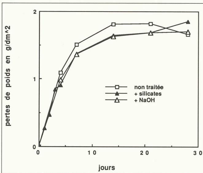
Fig. 2. — Pertes de poids dans l'eau du réseau.
