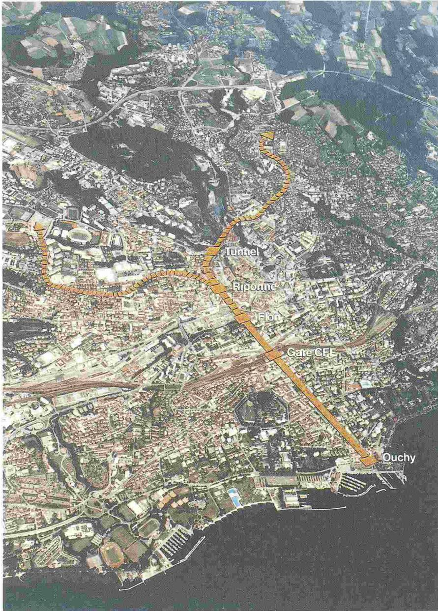
Fig. 7. – Proposition de prolongement du métro Ouchy-gare CFF-Flon vers la place du Tunnel avec deux extensions vers le nord-est et vers le nord-ouest. La ville de Lausanne qui s'étage du bord du lac (altitude 375 m) à l'autoroute de contournement (altitude 650 m) requiert des technologies de transport particulières pour vaincre des déclivités atteignant 11%.
