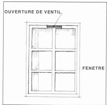
Fig. 18. – Ventilation par la fenêtre.
