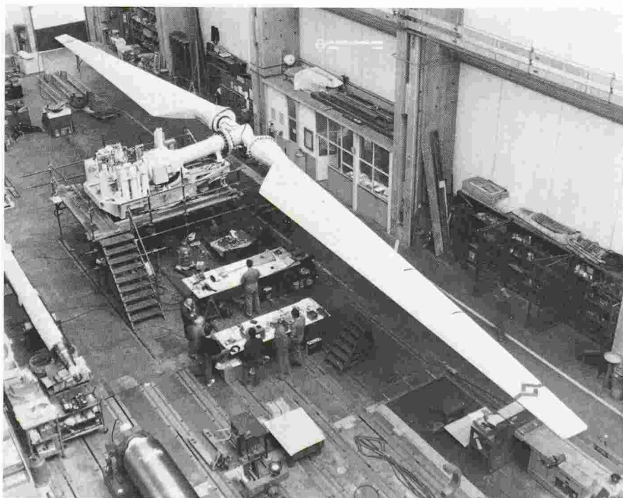
L'hélice de 32 m de diamètre d'une éolienne «Medit» dans les ateliers de De Pretto-Escher Wyss à Schio. Une éolienne de ce type tourne déjà en Sardaigne.
