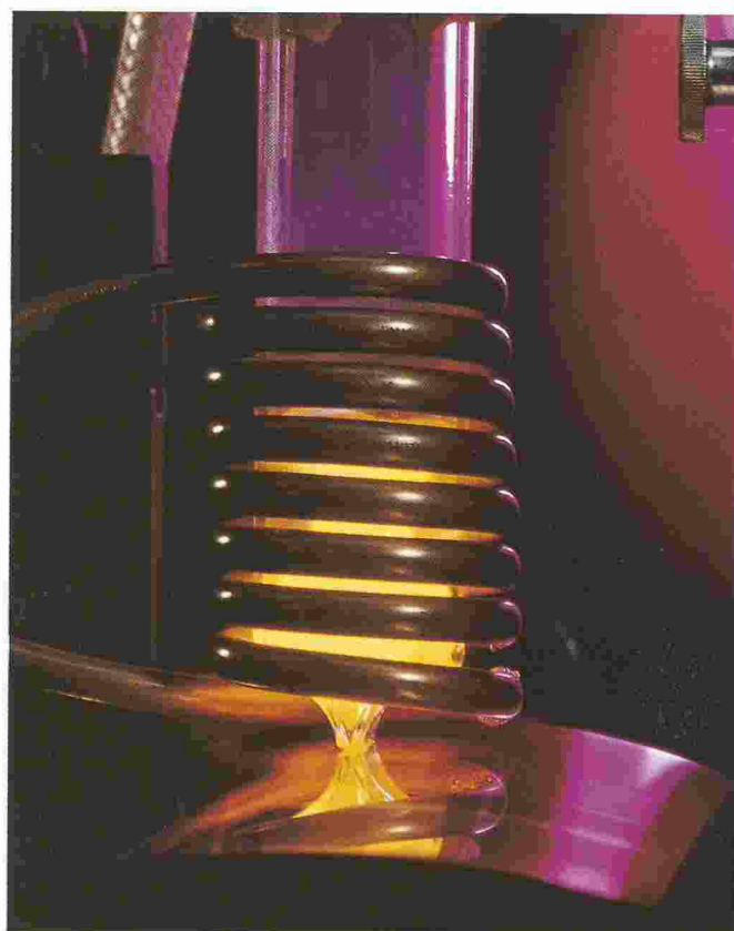
Le métal en fusion, projeté à travers une buse sur un rouleau de refroidissement, est continuellement étiré à une vitesse de 60 km/h et subit une trempe ultrarapide. (Photo Sulzer.)
