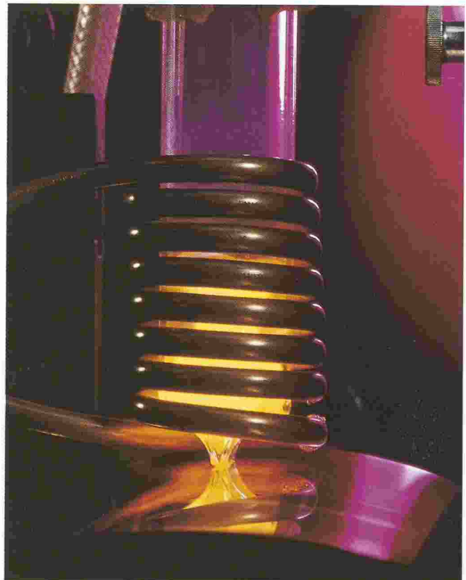
Le métal en fusion, projeté à travers une buse sur un rouleau de refroidissement, est continuellement étiré à une vitesse de 60 km/h et subit une trempe ultrarapide. (Photo Sulzer.)
