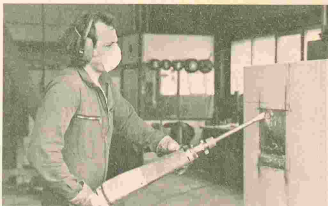
Le blindage résiste : pendant le laps de temps prescrit, il n'a pas été possible de percer sa cloison, même avec le marteau «Kango».
