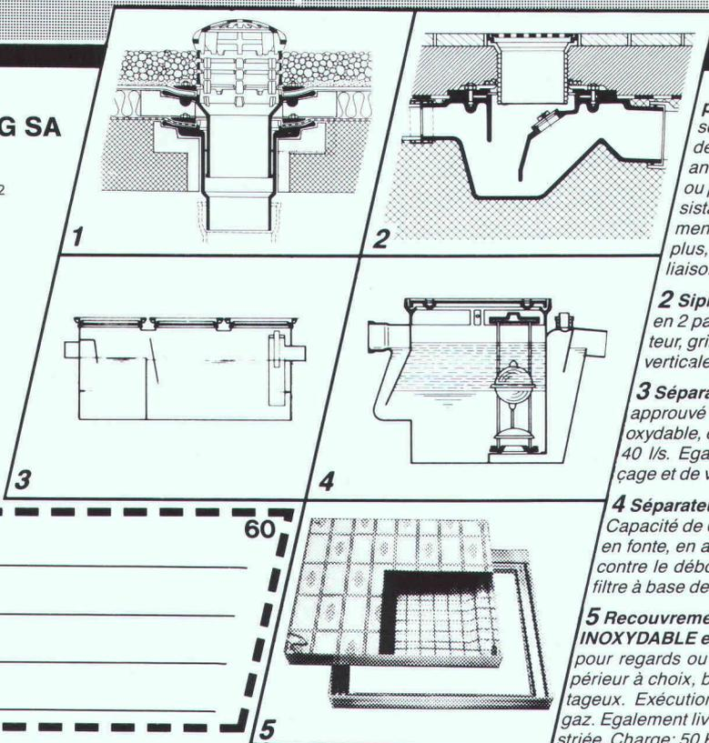
**1 Garniture d'écoulement en fonte pour toiture, PASSAVANT,** sorties verticale et latérale en une ou deux parties, réglable en hauteur avec anneaux de surélévation, grille sphérique, ou plate, ronde ou carrée, praticable, ou résistant au trafic lourd. Pourvue, non seulement d'une surface de collage, mais avec en plus, d'une bride de fixation assurant une liaison très résistante. Approuvé **ASPEE**.
