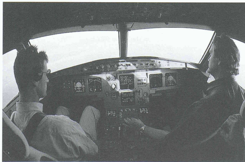
Le cockpit de l'Airbus A321 (identique à celui de l'A319 et de l'A320). Sur le tableau de bord, six écrans cathodiques remplacent les multiples instruments circulaires des avions des générations précédentes. Plus de volants, mais deux mini-manches le long des parois latérales. On distingue celui de droite, dans la main droite du copilote. (photo Clavadetscher)
