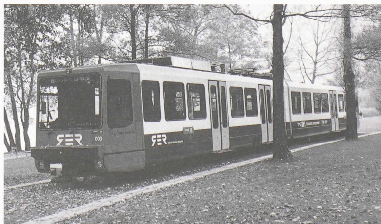
Rame automotrice du RER Genève-La Plaine, dont pourraient s'inspirer des rames bicourant aptes à circuler sur le TSOL et sur les voies CFF
