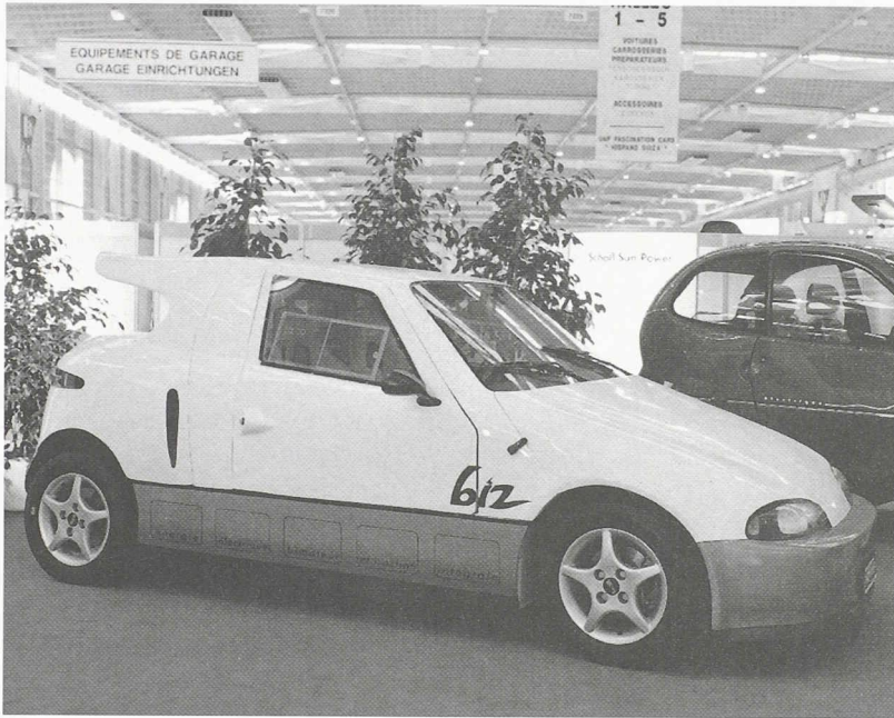
La nouvelle voiture électrique « Sport » à traction intégrale, entièrement conçue et réalisée par Scholl Sun Power, à Vernier/GE
