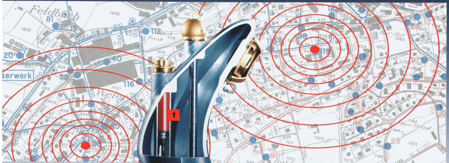
**1** Le système électronique de détection de fuite LOG 50 repère, situe, mesure, enregistre et traite les informations issues des bruits anormaux du réseau de conduites, permettant de déterminer avec précision les emplacements de fuites et ainsi de ruptures de conduite potentielles. Le système LOG 50 est mis en oeuvre de manière permanente ou périodique, selon les risques potentiels dans la zone à protéger.
