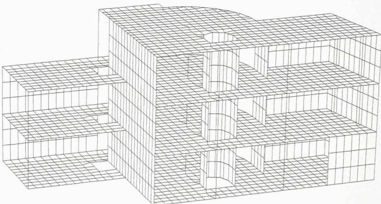
Fig. 1b.- Modélisation d'un bâtiment sur plusieurs étages:
