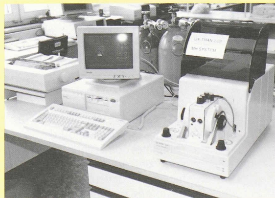
Dispositif Oxtran pour la mesure de la perméabilité à l'oxygène de films d'emballage et d'emballages complets
