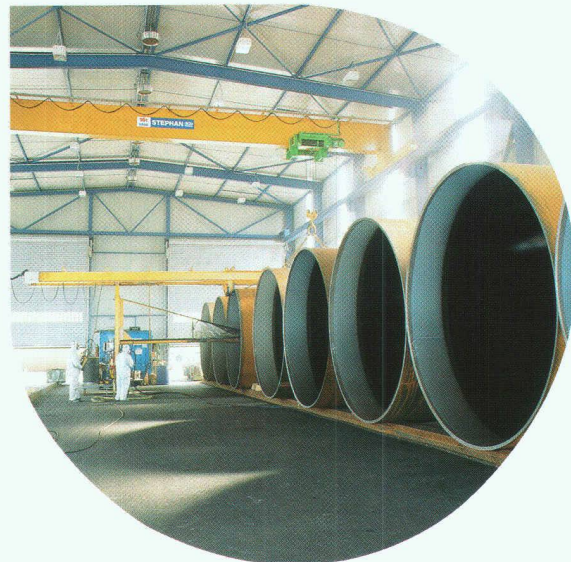
Cleuson-Dixence, revêtement industriel des tuyaux
