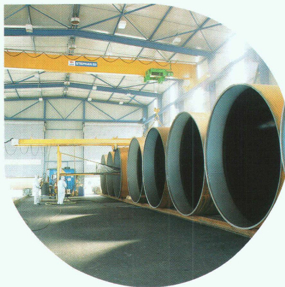
Cleuson-Dixence, revêtement industriel des tuyaux
