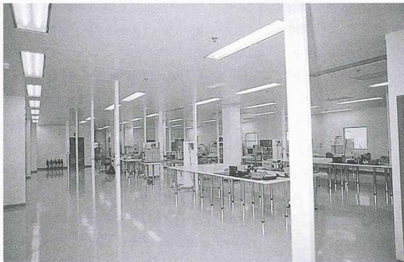
Fig. 1: Vue générale d'une salle blanche. Les parois et le plafond sont réalisés en tôle thermolaquée, le sol en époxy avec remontées arrondies. On notera l'intégration des luminaires et des grilles de soufflage dans les plafonds. Les poteaux verticaux fournissent l'ensemble des alimentations aux postes de travail, ce qui évite les percements dans les parois.
