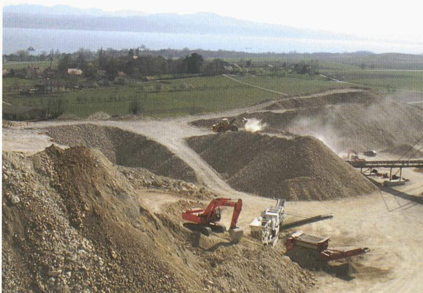
Fig. 10 : Criblage des matériaux (Photo Jean Jeker)
