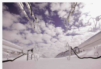
Anémomètres soniques faisant face à l'étendue du glacier de la Plaine Morte (©Jako Martinet)
