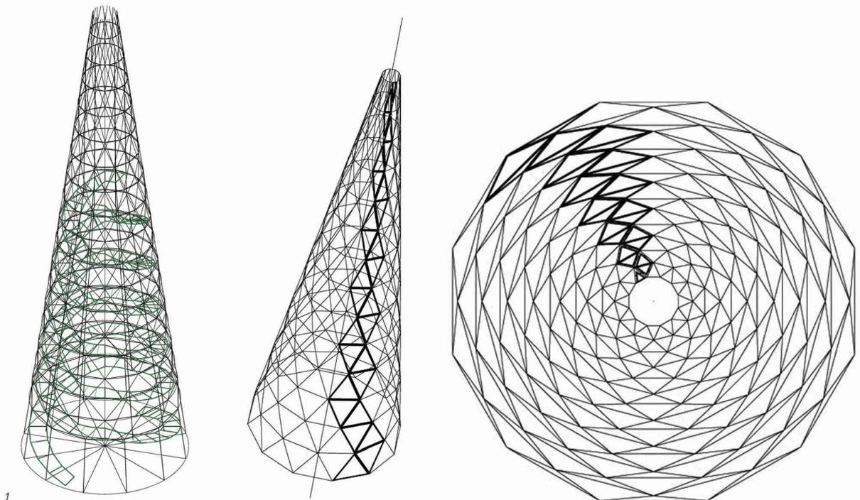
Fig. 1 : Géométrie d'ensemble de la tour, hauteur : 42 m
