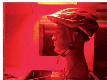
Modèle de tête avec casque de cycliste et simulation du rayonnement solaire par lampe infrarouge (Photo Empea)
