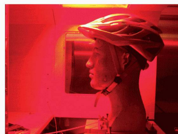
Modèle de tête avec casque de cycliste et simulation du rayonnement solaire par lampe infrarouge (Photo Emipa)
