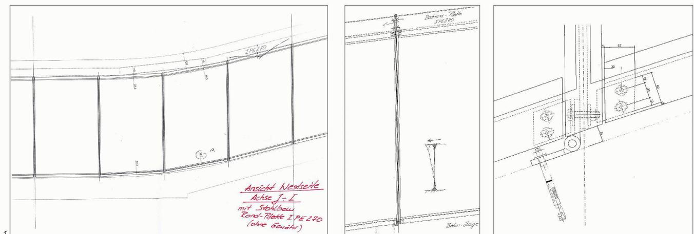
Fig. 1 : Système « montants-traverses » articulé pour les façades avec détail de la fixation basse sur relevé béton
