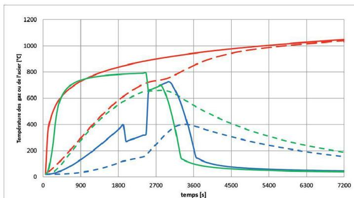
Elle a d'abord conduit à l'utilisation d'actions thermiques plus favorables par la définition de plusieurs scénarios de feux naturels<sup>4</sup> (fig. 6) et par la détermination des températures des gaz, obtenues par calcul informatique dans un modèle de zones<sup>5</sup>.
