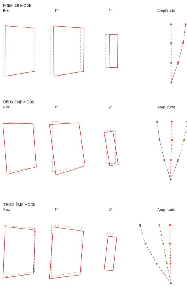
9 Modes de vibration selon les essais: rouge = mouvement transversal, bleu = mouvement en direction longitudinale, vert = mouvement en torsion
