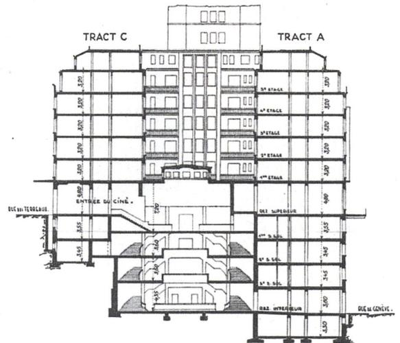
Abb. 2. Querschnitt durch Kino-Eingang und -Treppenhaus. — 1 : 600.
