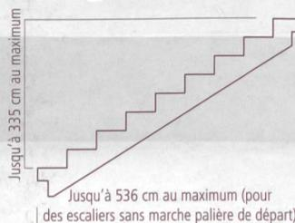
Les escaliers préfabriqués RATIONAL® sont conçus pour une hauteur d'étage allant jusqu'à 335 cm.
