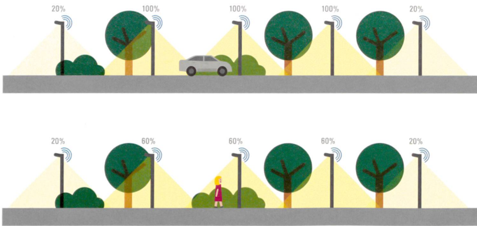
Communication entre les luminaires afin d'adapter l'intensité lumineuse
