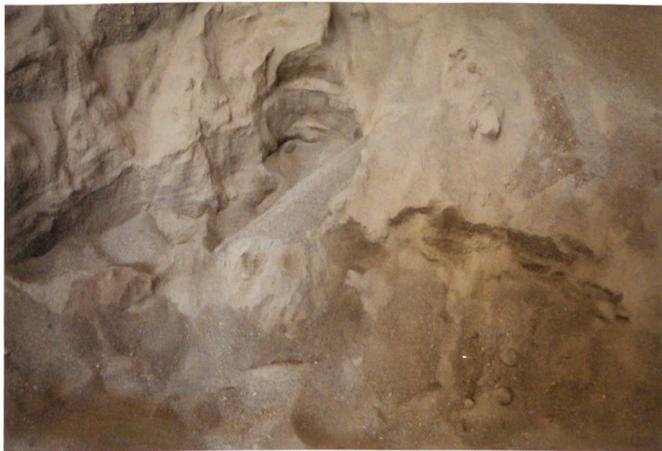
La terre séchée avant le conditionnement pour la formation des blocs
