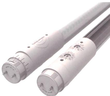
Parmi les solutions d'économie d'énergie, le tube LED est de plus en plus appelé à remplacer les anciens tubes fluorescents. Ils sont faciles à installer: il suffit généralement de changer l'ancien tube et de remplacer le starter par un starter «LED» et le tour est joué. L'ancien luminaire qui consommait 36W n'en consommera désormais plus que 18W. Sachant que les tubes fluorescents équipent majoritairement les communs d'immeubles, les garages, couloirs et autres passages éclairés
