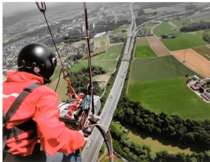
Relevé aérien d'un tronçon de l'autoroute A9 (photo Helimap System SA)
