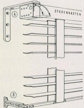
Wandbefestigung der Kirsch-Stores bei großer Ausladung. Kasten-träger **A** ist vorne aufklappbar und Storenkasten kann herausgehoben werden. **B** Arretiervorrichtung zum Einhängen
