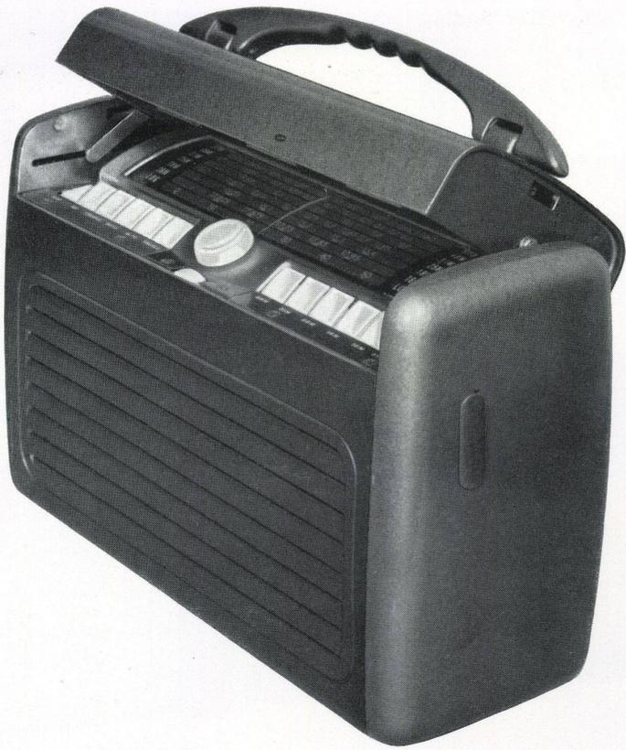
G-E Portable Modell 260 V. Leistungsfähiger 6-Röhren-Überlagerungsempfänger mit Hochfrequenzvorstufe und eingebauter Rahmenantenne. Eingebauter Accumulator mit selbsttätiger Aufladevorrichtung. Gleichzeitiges Spielen und Aufladen am Lichtnetz oder nach Wahl, geräuschloses Aufladen ohne Empfangsanschluß. Lange Spieldauer mit aufgespeichertem Eigenstrom, ca. 20 Stunden. Wahl der Wellenbereiche 5, gedehnte
