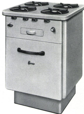
Bono-Gasherd mit Sockel-Unterbau, verstellbaren Bakelit-Unterlagen, gegen Herausfallen gesicherten Herdringen. Grau oder crème emailliert, mit 5 oder 4 Kochstellen. Speziell geeignet als Einbaherd in moderne Küchen. Bono-Apparate AG., Schlieren
