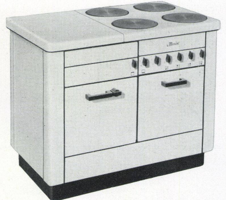
Maxim-Sockelherd mit 4 Kochplatten und einem seitlich angeordneten Backofen, je vierfach regulierbar / Auszieblech unter den Kochplatten / Geschirrschrank und Geräteraum / granit- oder elfenbein-emailliert / bequem zu reinigen. Firma Maxim AG., Aarau
