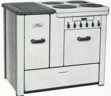
Le Réve – Kochherd: Elektrisch – Holz – Kohle, Modell F – 320. Zwei Kochstellen zu 260 mm Durchmesser / eine Kochstelle zu 180 mm Durchmesser / ein Backofen / ein Wärmeraum / ein Wasserschiff mit Nutzinhalt von 10 Liter / Rauchausgang hinten auf der Herdplatte, beliebig rechts oder links einsetzbar / feueremailliertes Stahlblechgehäuse / Herdgröße 736 mm breit, 710 mm tief, 810 mm hoch. Firma Le Réve S.A., Genève
