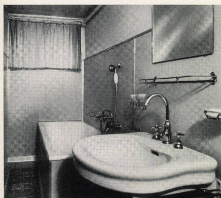
6a Wandbelag aus Glanz-Eternit Spezial-Platten in einem Badezimmer, Farbe hellgrün uni. Fabrikant: Glanz-Eternit A. G., Niederurnen/Gl.
