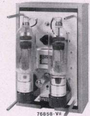
Thyralluxgerät 14 A mit abgenommenem Deckel
