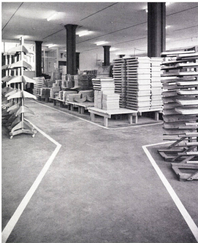
2 Zwischenlager im Erdgeschoß mit weiß- umrandeten Verkehrsflächen
