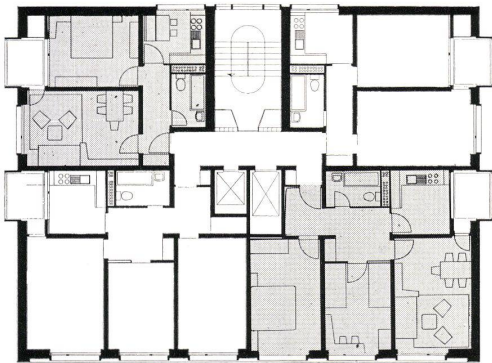
Grundriß des 19geschossigen Turmhauses mit Zwei- und Drei-Zimmerwohnungen
