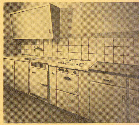
3 Die Auflösung des Herdes in die Elemente Kochplatten und Back- und Grillhaube bedeutet eine völlige Revolution in der Placierung des Herdes in der Küche. Die Kochplatten werden in die Arbeitsflächen eingelassen, der Platz darunter wird für Pfannen und Kochgeschirr benutzt. Diese Arbeitsfläche braucht nicht mehr wie bisher an die Wand gebunden zu sein, sondern kann, wenn es die Planlösung fordert, z. B. die Barriere zum Wohnraum bilden, in die die Kochplatten versenkt werden, so daß man vom Speisetisch aus das kochende Teewasser abheben kann. Auch der Backofen und Grill macht sich frei und klettert die Wand hinauf und ist wie der Kühlschrank eingebaut. Um die Bräunung des Gebäcks zu überwachen, muß sich die Hausfrau nicht mehr verrenken oder am herausgezogenen Auflauf verbrennen, sondern kann durch ein Glasfenster in den beleuchteten Backofen aufrecht stehend hineinschauen und, wenn der Kuchen gar ist, ihn in bequemer Ellbogenhöhe herausziehen.
