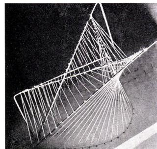
Dieser Entwurf (Abb. 10) enthält ein Konoide E; eine Fläche, die in der Hauptsache aus den zwei Konoide A und D besteht; die hyperbolischen Paraboloid K und G; einen Verbindungskegel L und zwei als Ein- und Ausgang fungierende offene Dreiecke. Man sieht, daß die zwei Spitzen, die entstanden sind durch die zwei Geraden, die vom Ende einer der Tüllen aufsteigen, hier durch eine dritte, über dieser Tülle aufragenden Spitze im Gleichgewicht gehalten werden.
