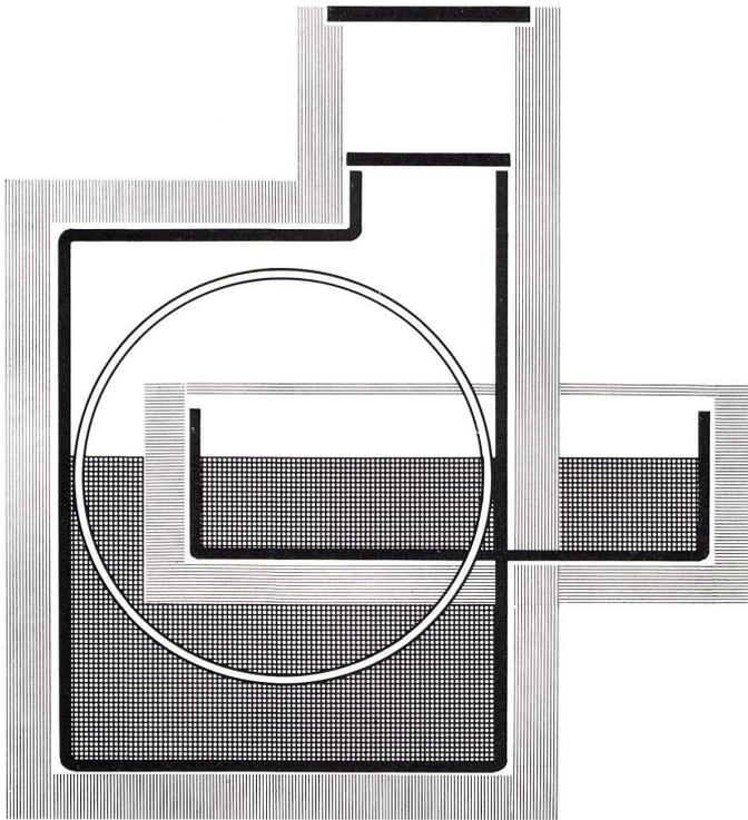
Der Plascon-Tank ist die Konstruktion eines Flüssigkeitsbehälters aus Plastik und Beton
