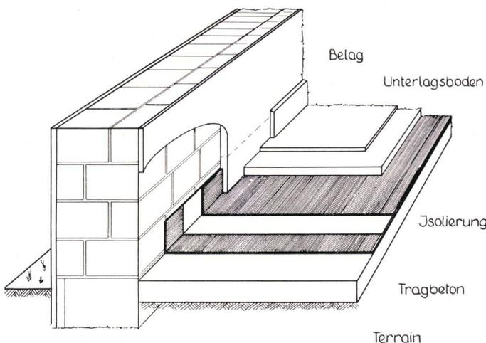
kommen nicht mehr vor, wenn die Planung mit der ROBIT-Dampfsperre beginnt. Diese 100prozentige Sperrschicht verhindert die Durchfeuchtung, gestattet das Verlegen der empfindlichsten Bodenbeläge und verbilligt die Konstruktion, da der Hohlraum wegfällt.
