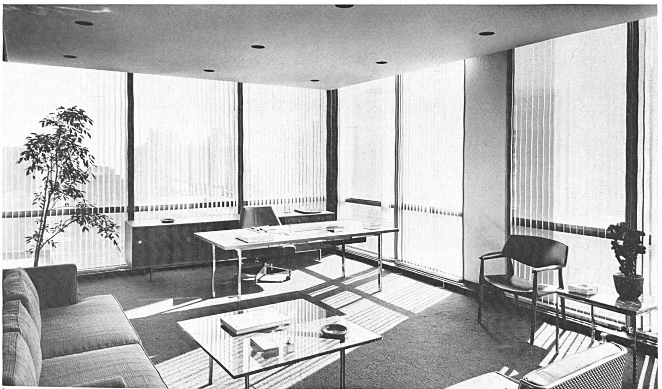
3 Direktionsbüro. Innere senkrechte, zusammenschiebbare Sonnenblenden, darunter Ausblasöffnungen für konditionierte Luft. Bureau de direction; brise-soleils intérieurs assemblables verticalement, au-dessous les grilles de ventilation pour l'air conditionné. Board office. Internal perpendicular folding blinds, underneath expulsion points for air-conditioning.
