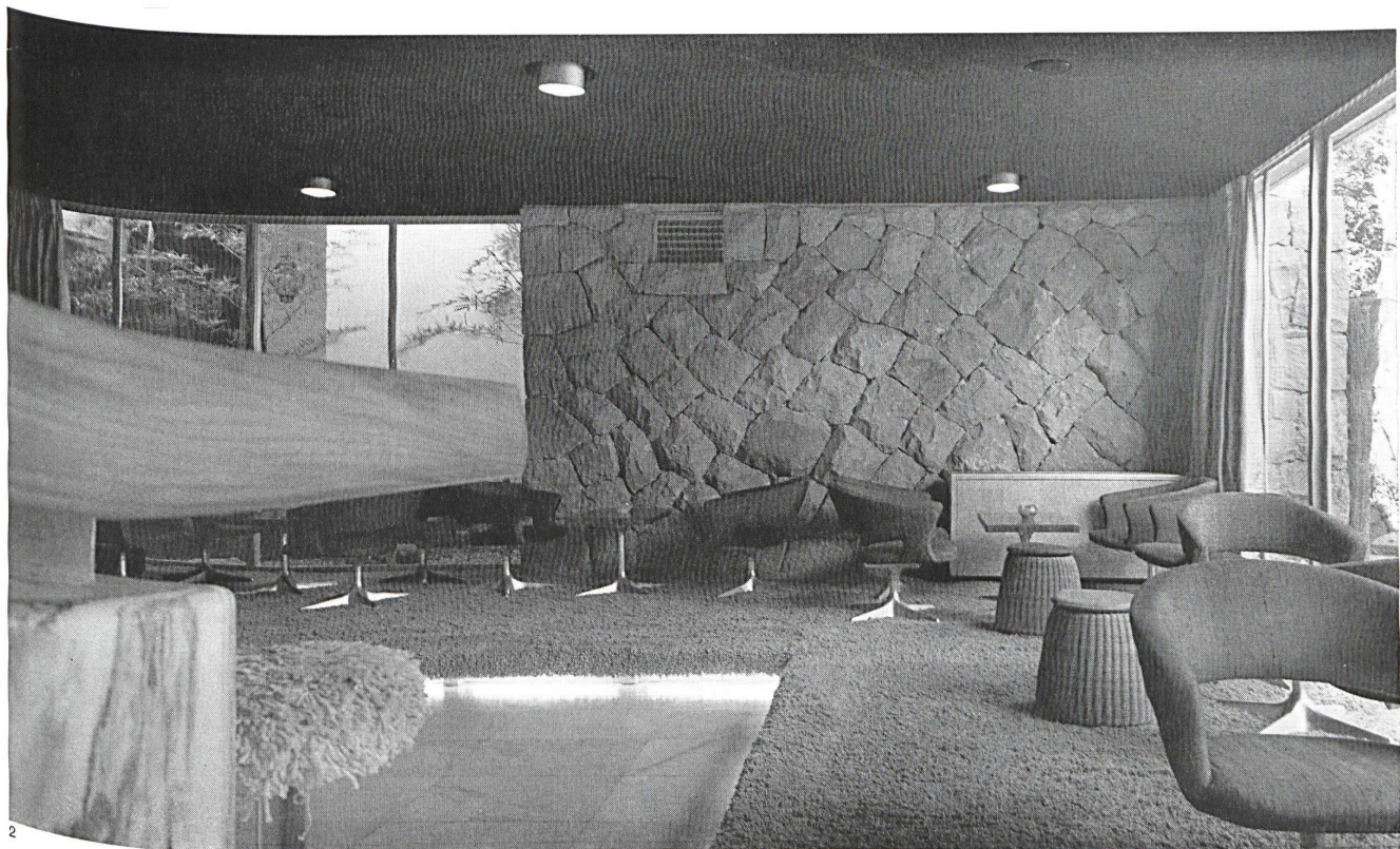
Le dancing au niveau du jardin; à gauche le bar et la piste de danse, légèrement enfoncée. Sol: tapis. Piste de danse et bar: Marbre. Parois: Mur cyclopéen en pierres brutes. Plafond: Zonolite noir. Dessus du bar: Bois de Zelcova. The dancing place on the garden level, left, bar with dancefloor, slightly sunken. Floor: Carpeting. Dancefloor and bar: Marble. Wall: Massive masonry, quarry stone. Ceiling: Black Zonolite. Bar top: Zelcova wood.
